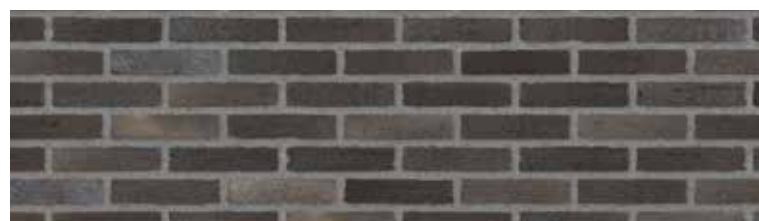
Tegel i livfull mörkgrå kulör med ljus fog. Ingjutes i betongelement med halvstensförband.
